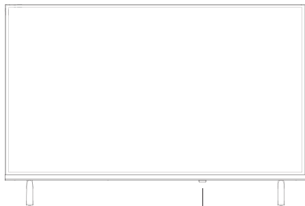
кнопка питания/инфракрасный датчик/индикатор питания
